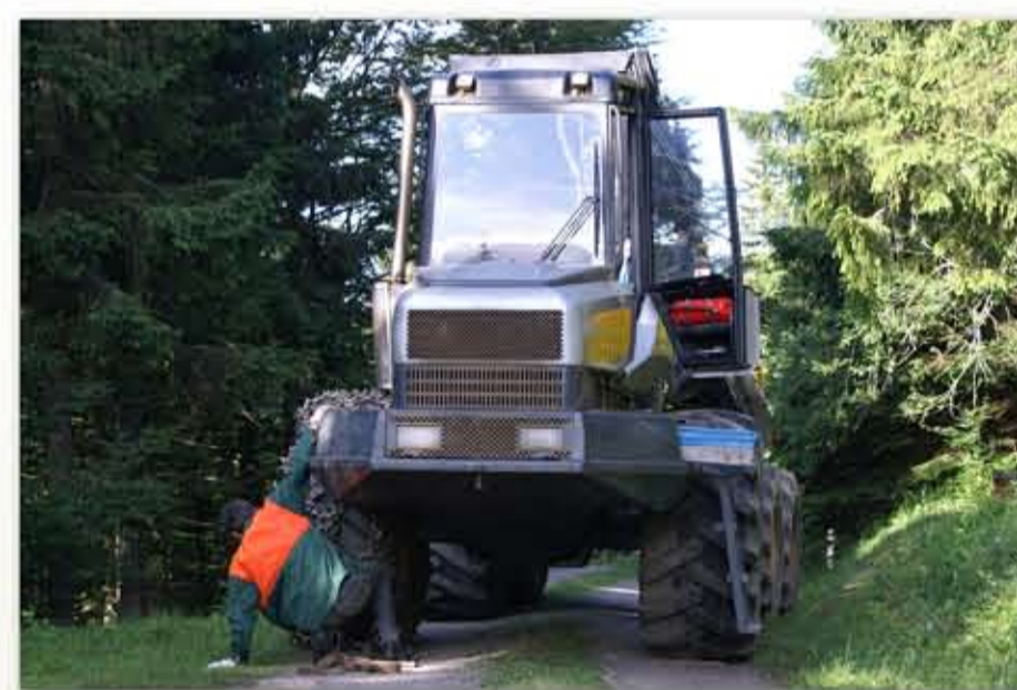
Wegen des steilen Geländes montiert der Unternehmer Ketten auf die Räder seiner Maschine.
